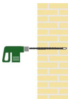
Huller bores med et 12 mm bor i fugen
